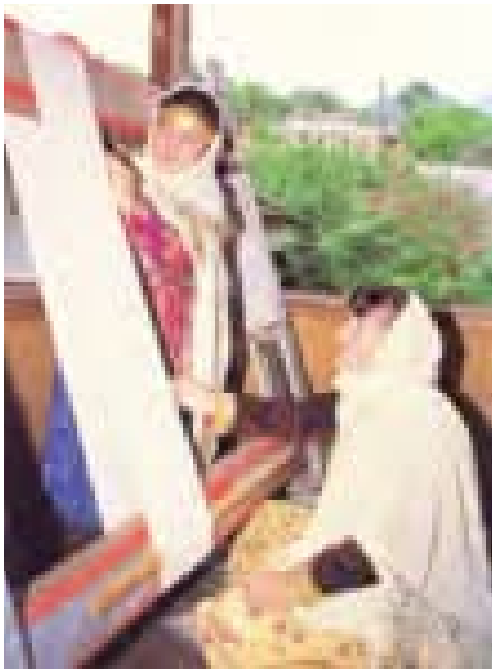
Илл. 191. Натяжка основы на станок. Лагич. Азербайджан. 1996 год.
